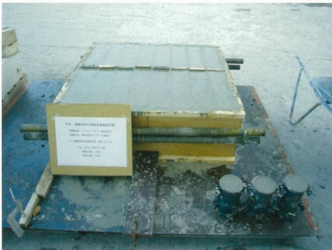
写真-4. コンクリート打設後、養生前状況
