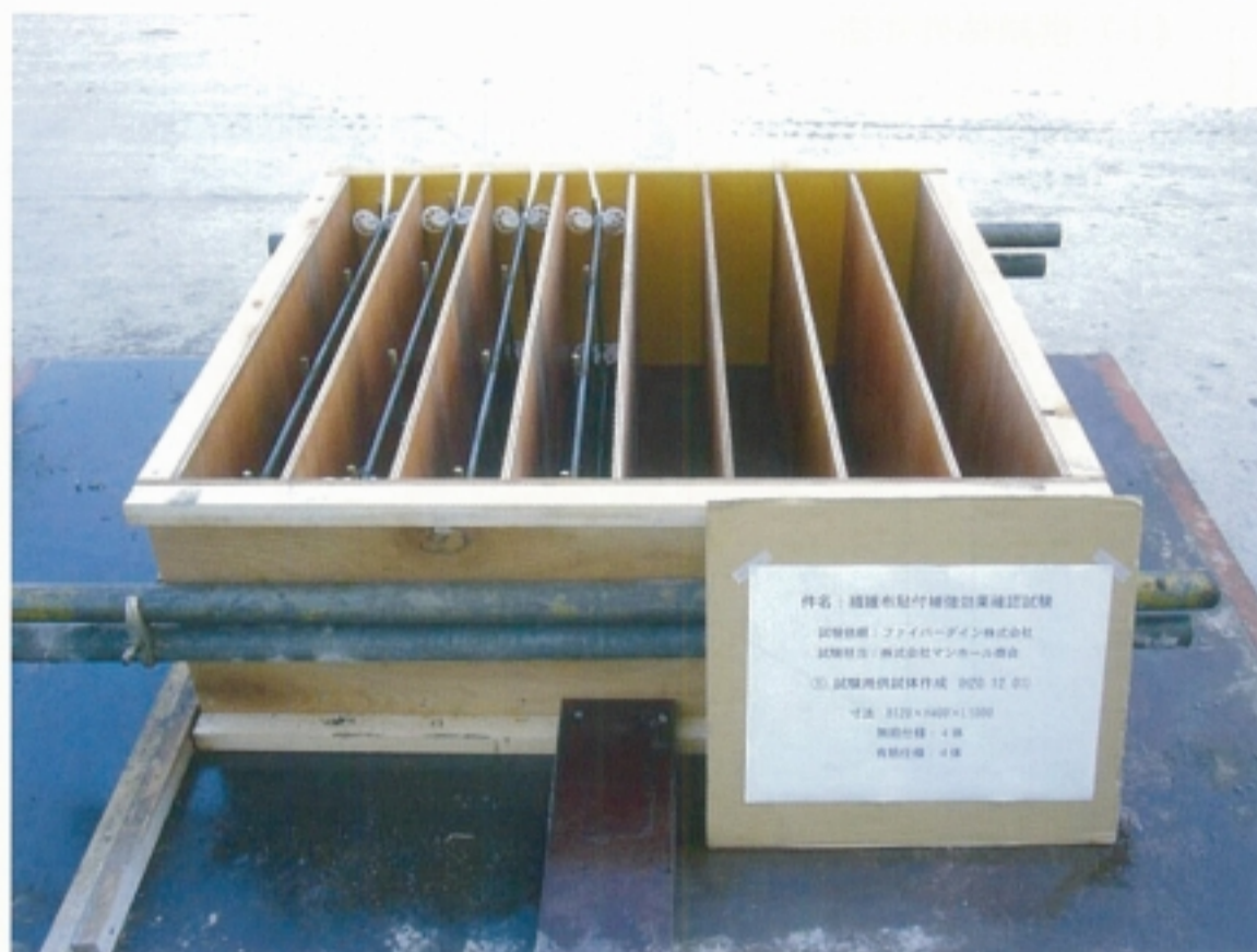
写真-1. 供試体型枠
