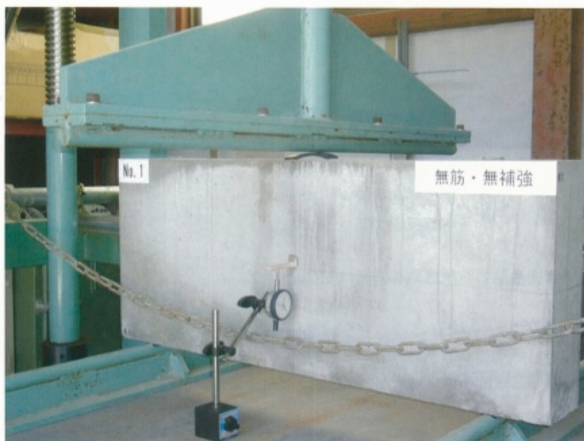
写真-8. ダイヤルゲージ取付部
