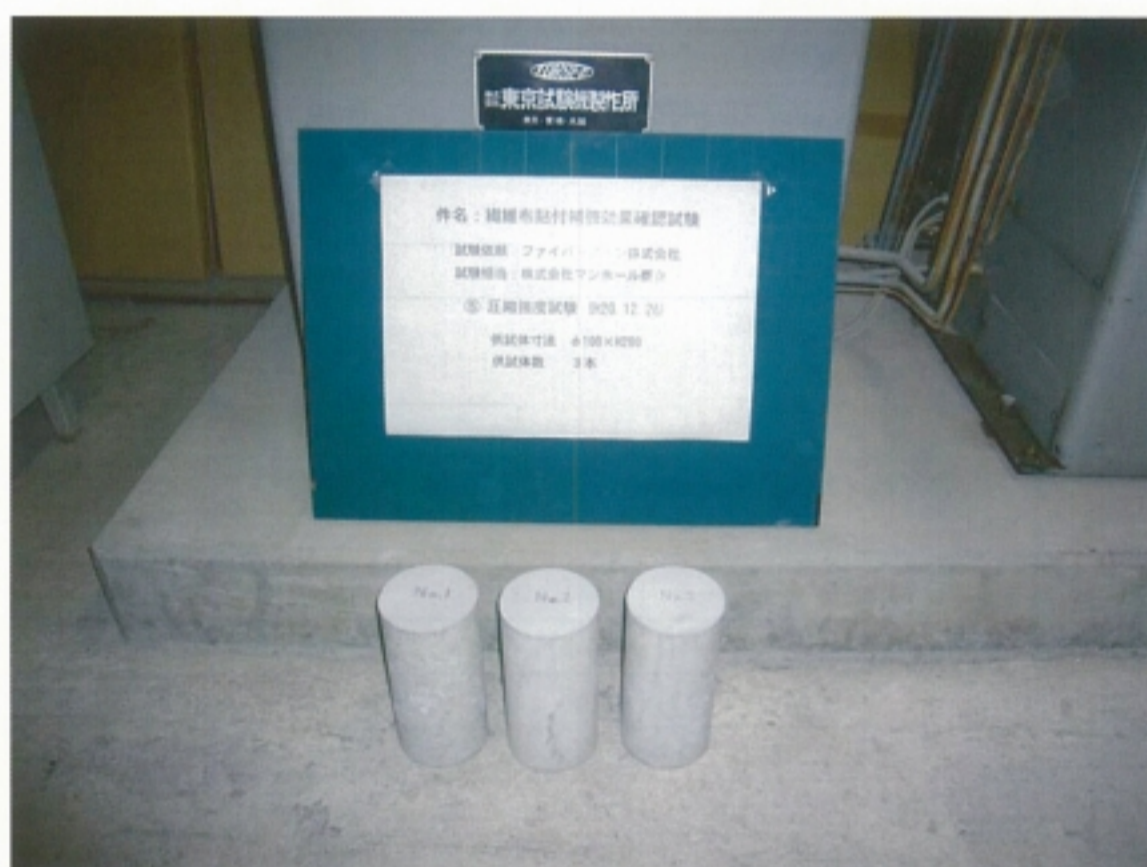
写真-12. 試験日材齢での圧縮強度試験
