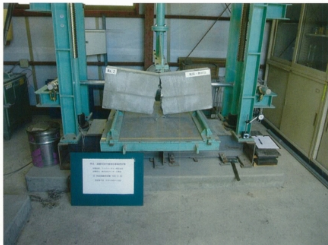
写真-9. 供試体の破壊状況 [a-2：無筋・無補強]
