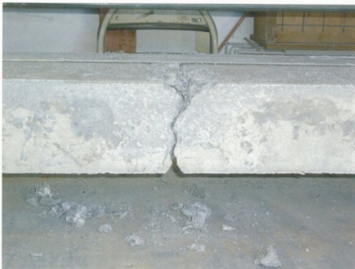
写真-15. 供試体底面の破壊ひび割れ [b-1：無筋・繊維布貼付]
